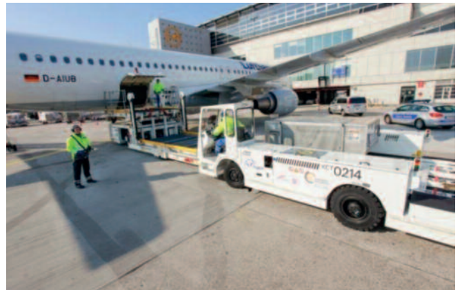
Elektrisch betriebener Containertransporter in Zusammenarbeit mit einem Palettenhubwagen bei der Flugzeugabfertigung in FRA
